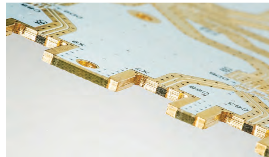
Composite PCB, top layer Ro4003, edge plating
