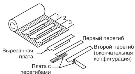
Рис. 7. Финальное расположение гибкой платы на мультизаготовке
